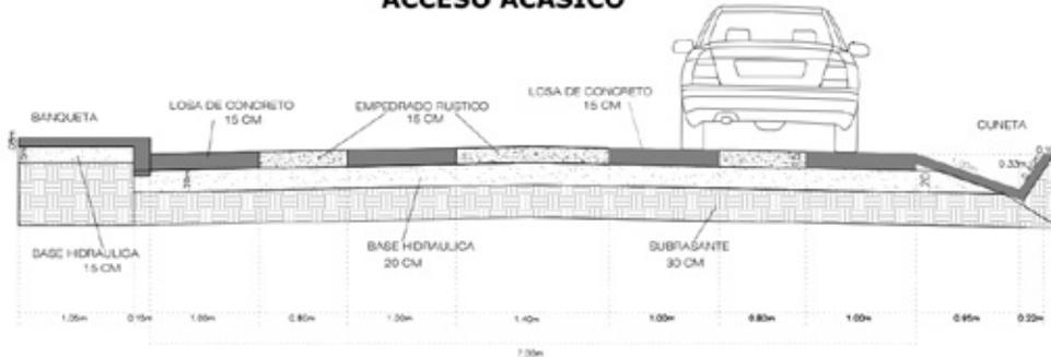
Figura 26. Sección arquitectónica del pavimento ecológico para el acceso a Acasico.
