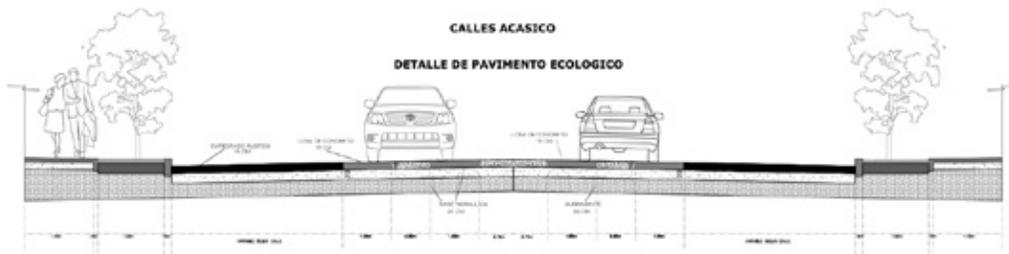
**Figura 4. Sección arquitectónica del pavimento ecológico para las vialidades locales de Acasico.**
